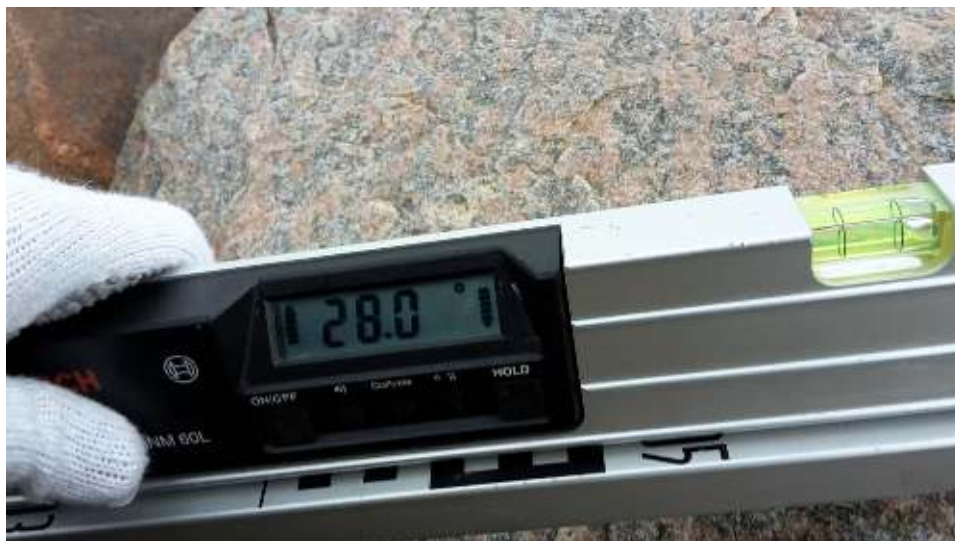
Figur 3-2 Vinkel på skråningsbeskyttelse bag bølgebryder 10. 1:1,8
