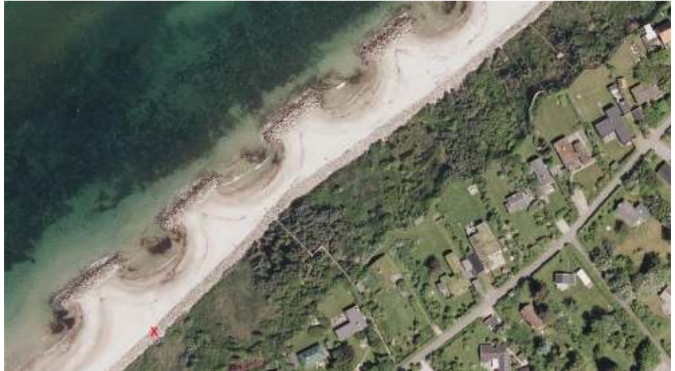
Figur 4-21 Bølgebryder 4-7, Rødt X markere observation af underminering.
