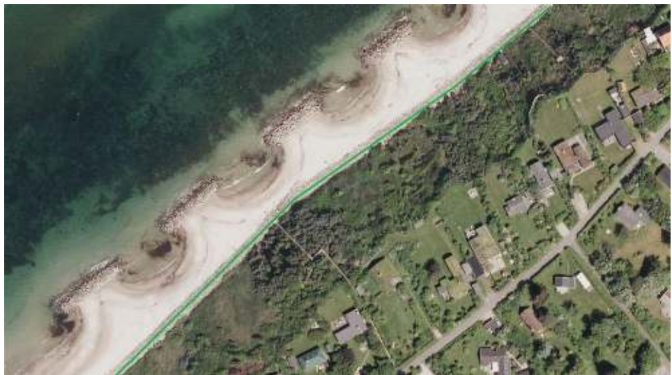
Figur 3-9 Bølgebryder 4 – 7, Den grønne linje indikerer at skræntfodssikringen har topkote i ca. +3,25.
