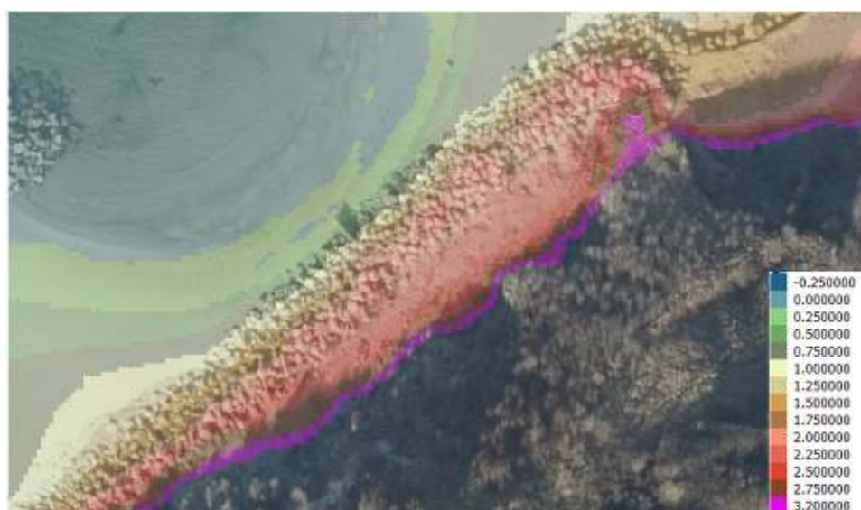
Figur 3-13 Højdedata af skræntfodssikring bag bølgebryder 13.
