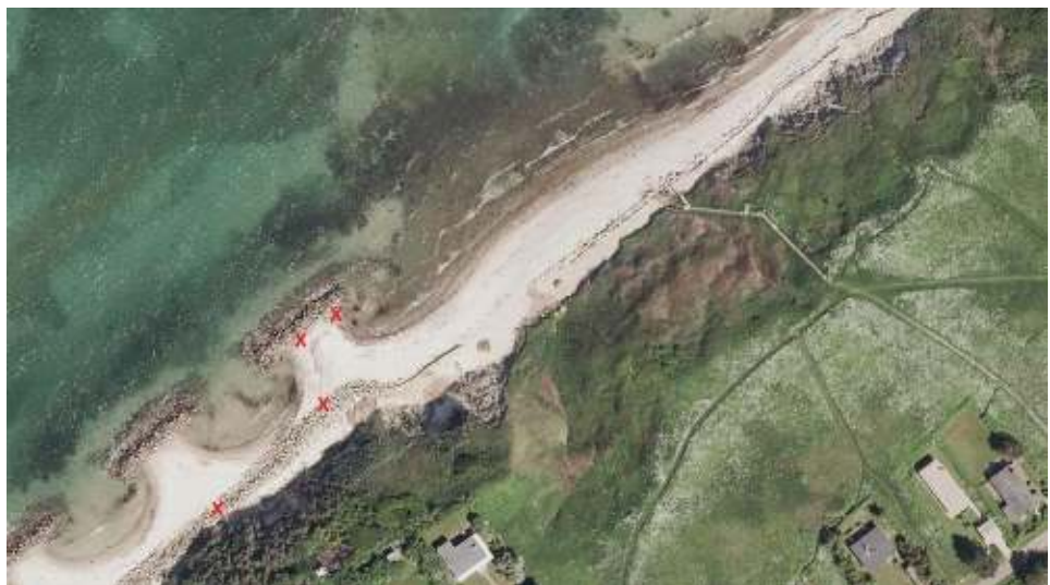
Figur 4-9 Bølgebryder 12 og 13, Rødt X markere observation af blottet filterlag.
