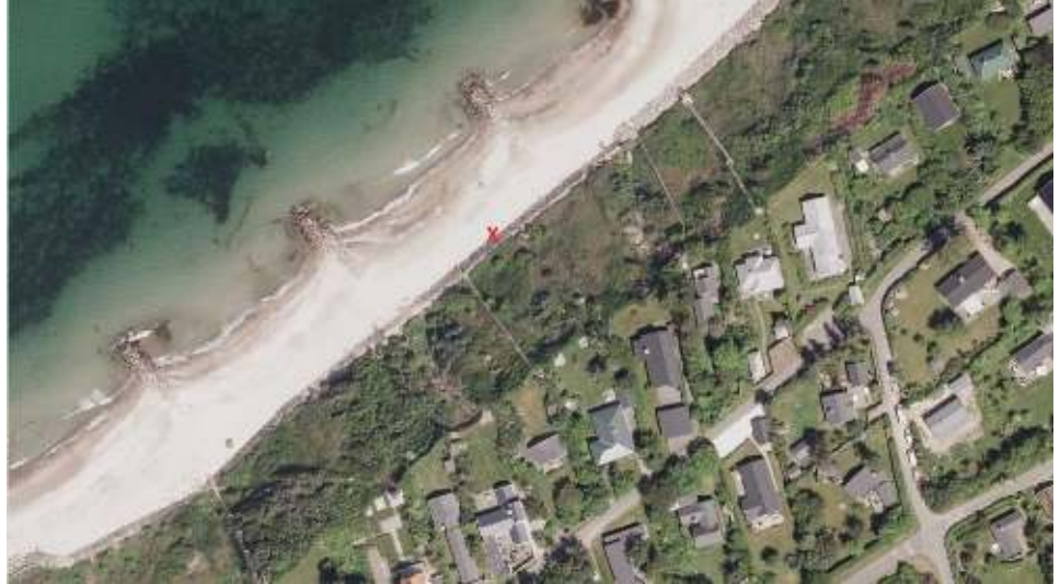
Figur 4-20 Høfde 1 til 3, Rødt X markere observation af underminering.
