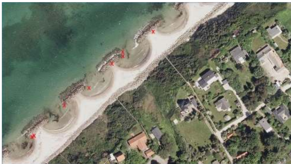
Figur 4-13 Bølgebryder 8 til 11, Rødt X markere observation af fejlplacerede dæksten.
