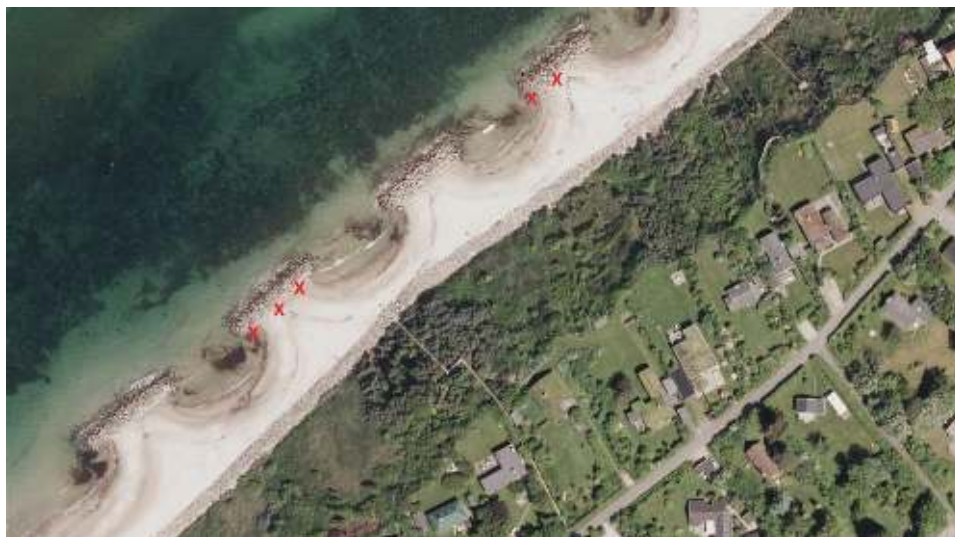
Figur 4-12 Bølgebryder 4 til 7, Rødt X markere observation af fejlplacerede dæksten.
