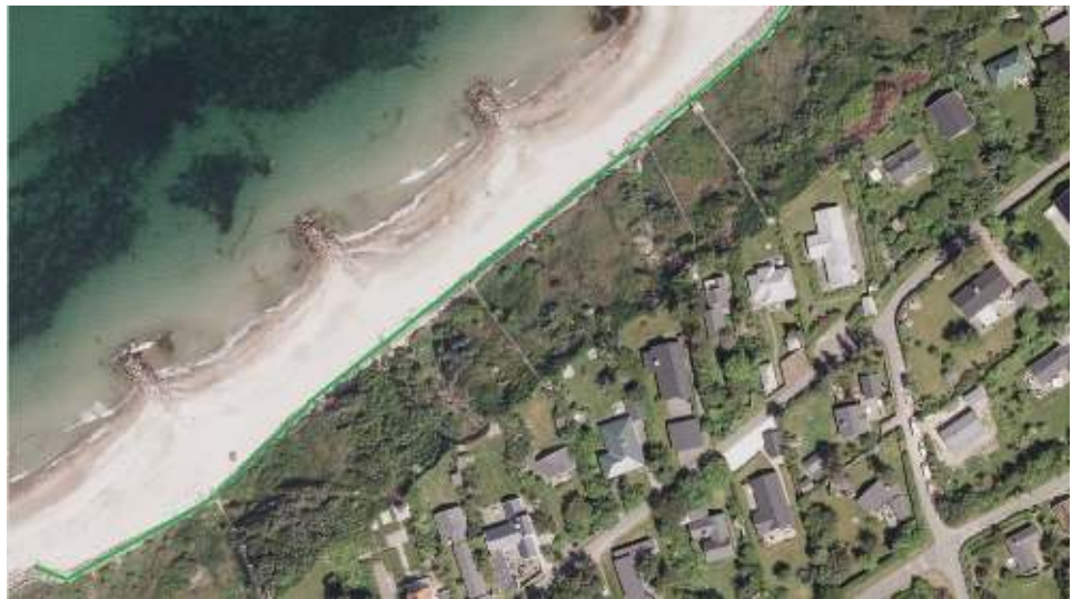
Figur 3-8 Høfte 1 – 3, Den grønne linje indikerer at skræntfodssikringen har topkote i ca. +3,25.
