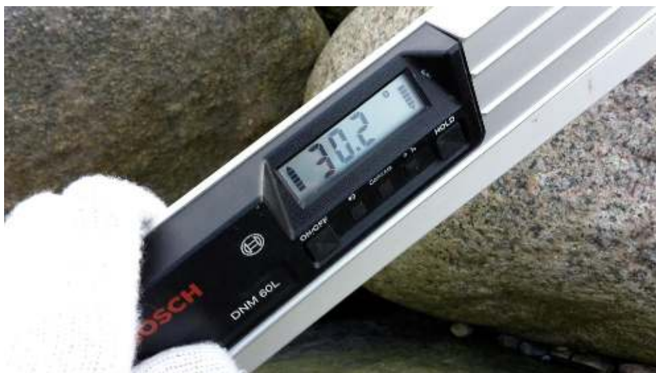
Figur 3-3 Vinkel på skråningsbeskyttelse bag bølgebryder 8-9.
