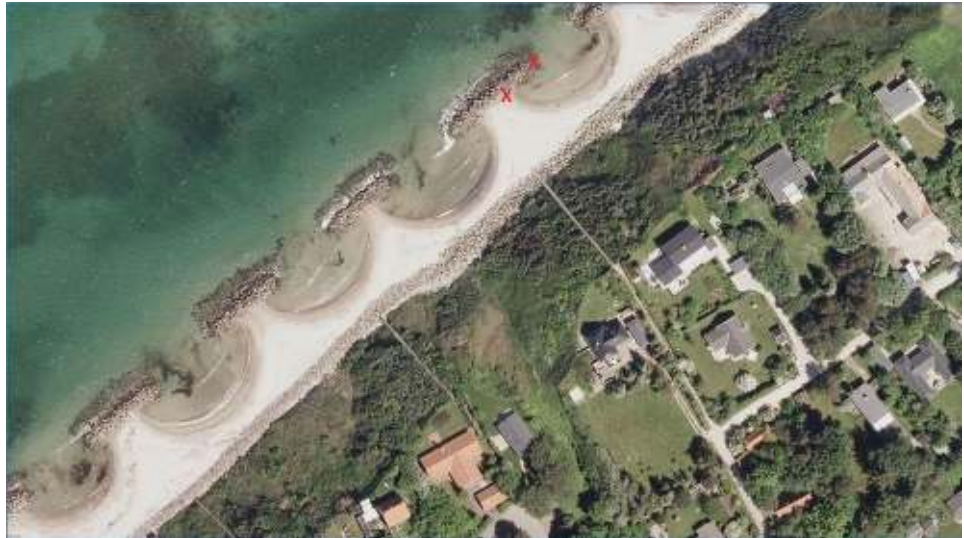
Figur 4-8 Bølgebryder 8 til 11, Rødt X markere observation af blottet filterlag.
