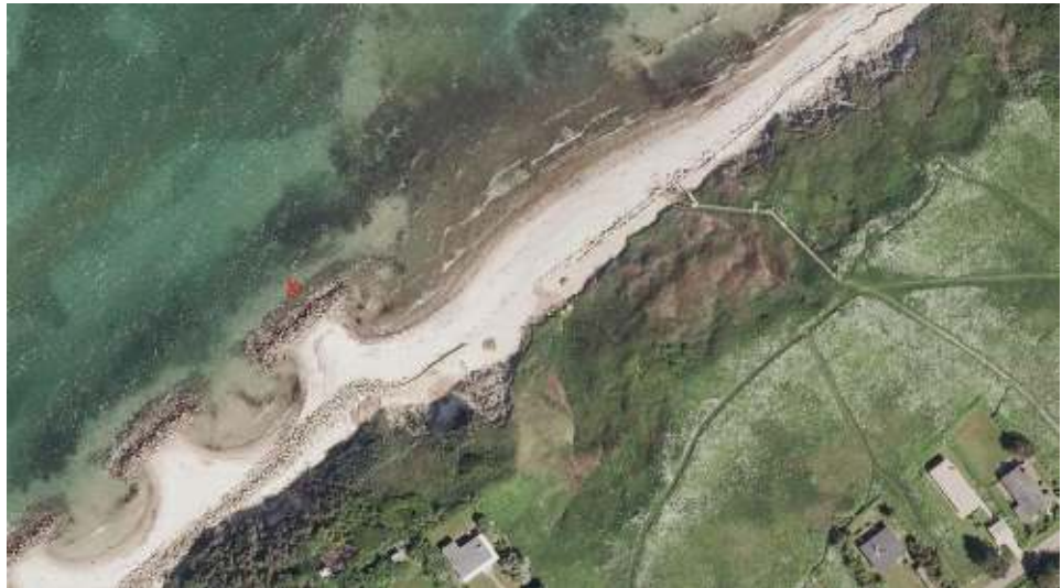
Figur 4-14 Bølgebryder 11 og 12, Rødt X markere observation af fejlplacerede dæksten.
