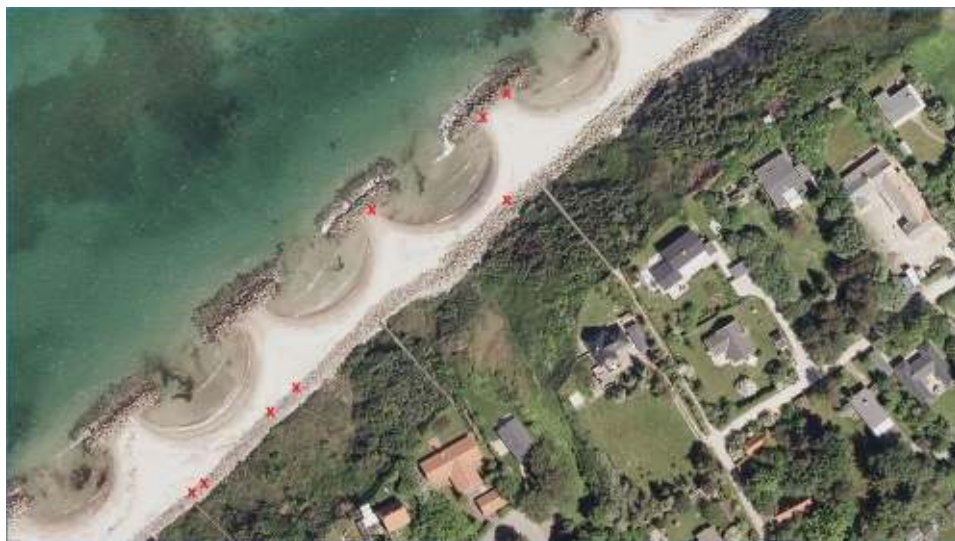
Figur 4-3 Bølgebryder 8 til 11, Rødt X markere observation af blottet fibertekstil.
