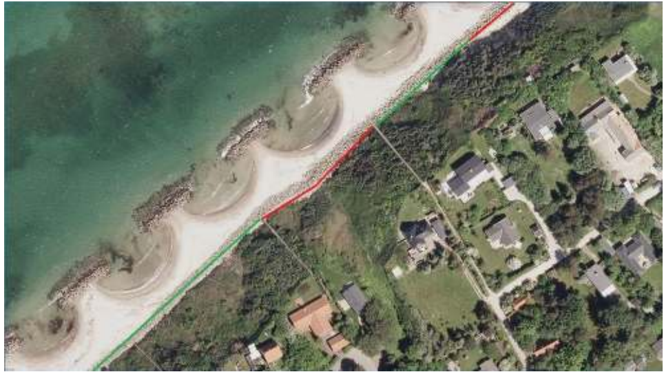
Figur 3-10 Bølgebryder 8 – 11, Den grønne linje indikerer at skræntfodssikringen har topkote i ca. +3,25, den røde linje indikere hvor niveauet er for lavt.
