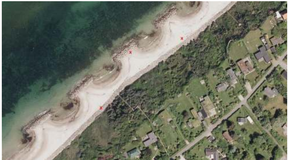
Figur 4-2 Bølgebryder 4 til 7, Rødt X markere observation af blottet fibertekstil.
