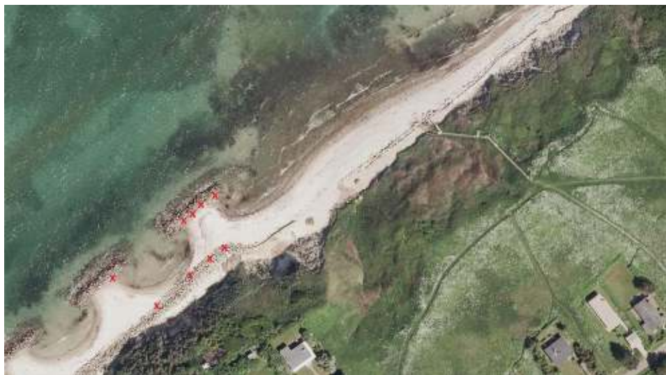
Figur 4-4 Bølgebryder 12 og 13, Rødt X markere observation af blottet fibertekstil.
